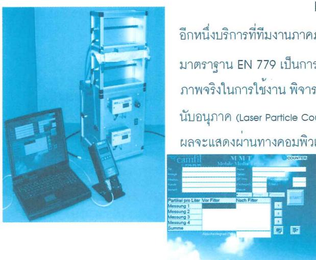
อีกหนึ่งบริการที่ทีมงานภาคภูมิใจ เครื่องทดสอบประสิทธิภาพตัวกรอง ตามแบบ มาตรฐาน EN 779 เป็นการทดสอบ ประสิทธิภาพแผ่นกรองเพื่อแสดงถึงประสิทธิภาพจริงในการใช้งาน พิจารณาอนุภาค ที่มีขนาด 0.3 μm-0.5 μm โดยใช้เครื่องนับอนุภาค (Laser Particle Counter) และ สามารถตรวจสอบการรั่วของ HEPA Filter ผลจะแสดงผ่านทางคอมพิวเตอร์ ซึ่งบันทึกเป็น TXT file และสามารถบันทึกท่อออก มาเพื่อใช้เป็นหลักฐานประกอบการทดสอบได้ด้วย ท่านผู้สนใจติดต่อได้ที่ คุณปิยะพร 0-5070-1093
