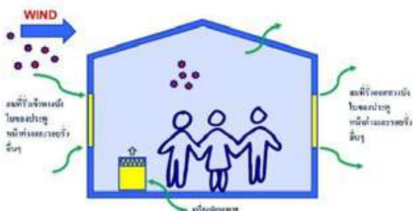
รูปที่ 3: แสดงการจัดการกับ PM2.5 ภายในห้องด้วยการฟอกและโดยการใช้ OAU ร่วมกับเครื่องฟอก (OAU ย่อมาจาก Outdoor Air Unit ซึ่งเป็นชื่อย่ออีกชื่อหนึ่งที่นิยมใช้เรียกตัว Positive Pressure Fresh Air Unit)
