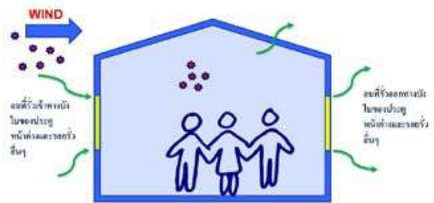
รูปที่ 2: แสดงการรั่วของลมเข้ามาภายในอาคารผ่านรูรั่วตามช่องเปิดต่างๆ อาทิเช่นทางบังใบของหน้าต่าง เป็นต้น การรั่วของลมเข้ามาภายในห้องตามธรรมชาตินี้จะนำเอา PM2.5 เข้ามากับลมด้วย
