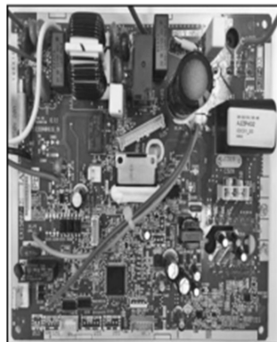
รูปที่ 2) ตัวอย่างของแผ่นวงจร PCB แบบอินเวอร์เตอร์เทียบกับแผ่นวงจร PCB ที่ไม่ใช่อินเวอร์เตอร์
