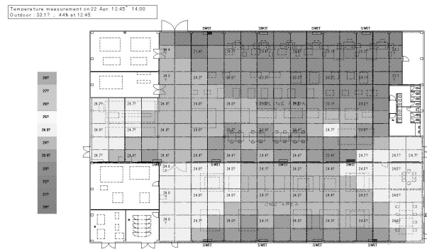
รูปที่ 6 : ตัวอย่างแผนภูมิการกระจายตัวของอุณหภูมิห้องที่ค่อนข้างสม่ำเสมอจากระบบจ่ายลมเย็นแบบ SWIT
